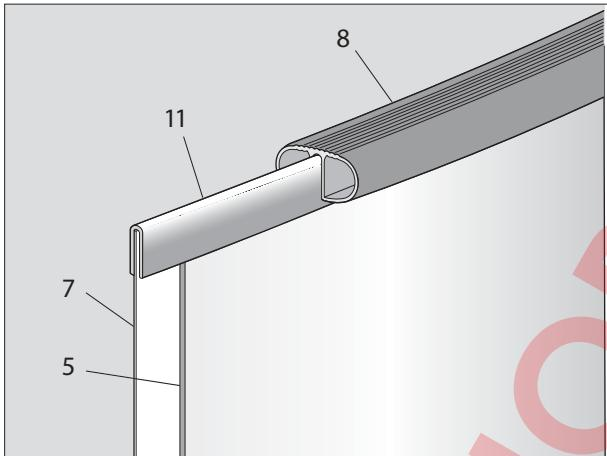
Настенную часть пленки (7) равномерно приподнять и навесным кантом (11) навесить на стальную стенку (5). Чтобы стенка (5) оставалась закругленной и чтобы зафиксировать навесной профиль (11), установите после навешивания элемент профиля поручня (8). Теперь продолжайте навешивание до тех пор, пока вся пленка (7) не будет навешена. Если на поверхности пленки образуются косые складки, то их можно удалить, только если снова снять профиль поручня и заново навесить пленку.
