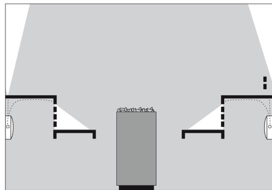
Kuidut ovat kuoritettua 2mm/4mm lasikuitua, joka kestäää max 180°C lämpötilan.
